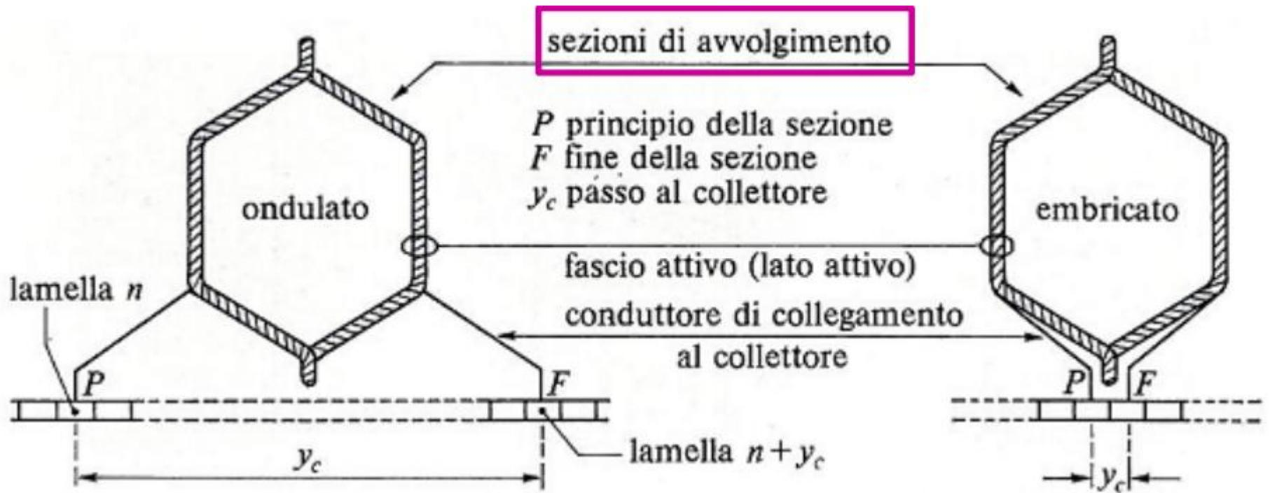
Bobina per avvolgimento ondulato: i terminali (principio e fine) sono connessi a lamelle del collettore tra loro «lontane» (passo al collettore  $y_c > 1$ )
